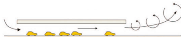
Rysunek B: Strumień powietrza (impuls) + turbulencja ruchu drogowego + wpływ wiatru i prędkość powietrza w tunelach.
